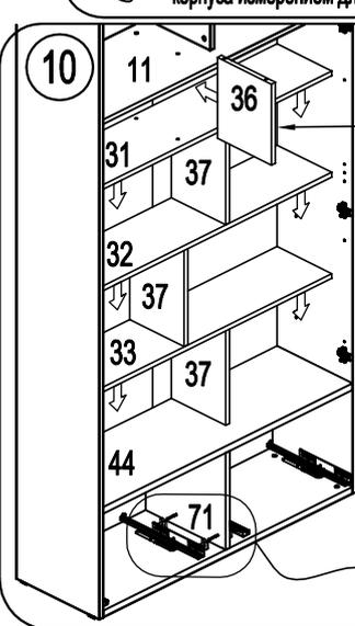
После установки полок 33, 32 и 31, завернуть фиксирующие винты в стяжках.
